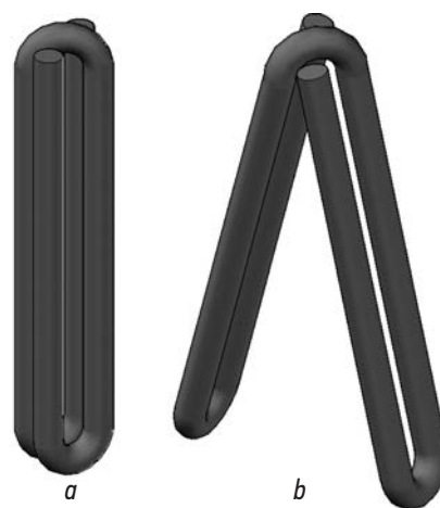
Рис. 3. Модель компрессионной клипсы из никелида титана с памятью формы в состоянии сомкнутых (а) и разомкнутых (б) ветвей
