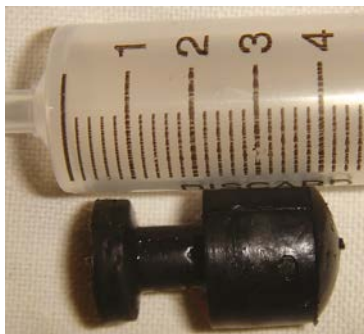
Рис. 5. Извлеченная резиновая пуля с металлическим сердечником
